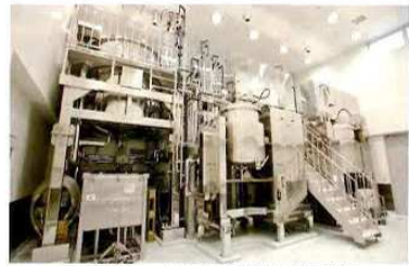
小ロットから経済ロットまで対応可能な大阪工場の溶解器・乳化装置
